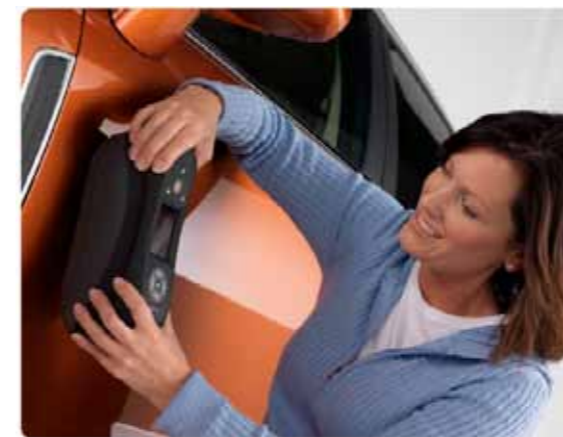
图5 利用MA98型多角度分光光度仪对外饰涂料进行检测
