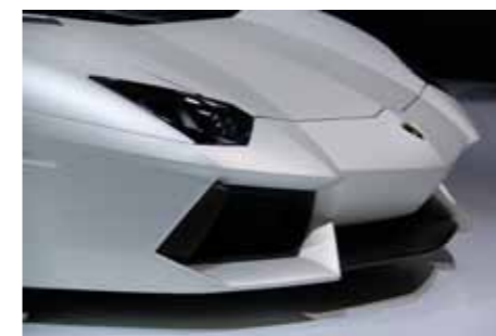
图2 Lamborghini Aventador使用的哑光效果 珠光漆，哑光漆的柔和与珠光漆的变化完美地结合。
