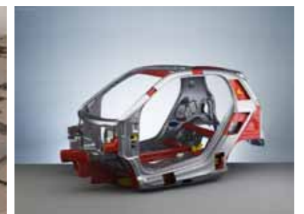
图3 Smart暴露的笼式金属车身结构反而成就了与众不同的车身分色方式
